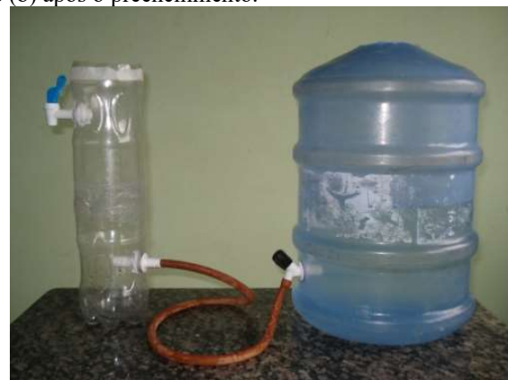
Figura 4 – Sistema reservatório filtro anaeróbico: (a) antes e (b) após o preenchimento.
