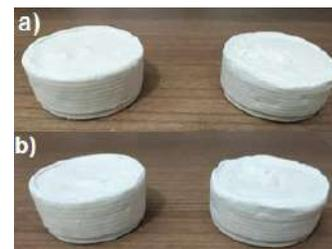
Figura 4 – Teste da rachadura: a) 01 dia e b) 06 dias de imersão em água
