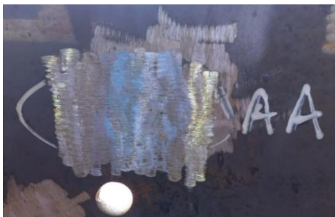
FIGURA 11. Correção da abertura de arco. Fonte: Autor (2023).
