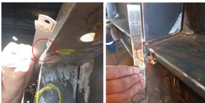
FIGURA 8. Redução localizada no metal de base. Fonte: Autor (2023).
