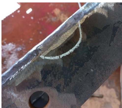
FIGURA 15. Correção da porosidade vermiforme. Fonte: Autor (2023).
