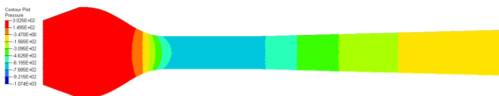
FIGURA 12. Variação da pressão estática ao longo do túnel de vento. Fonte: de autoria própria.
