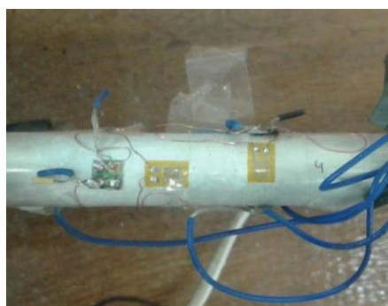
FIGURA 10. Representação de extensômetros colados na barra do dispositivo original.
