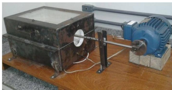
FIGURA 1. Primeira versão do dispositivo para ensaios de fadiga em flexão plana.
