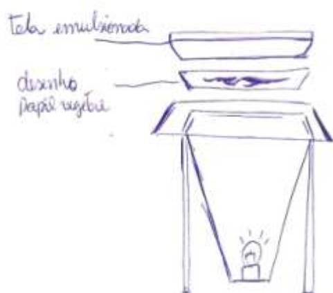
Figura 18, Esquema revelação da tela de serigrafia
