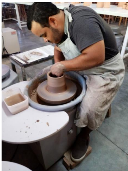
Criação das peças em torno elétrico Stecno SD-208
