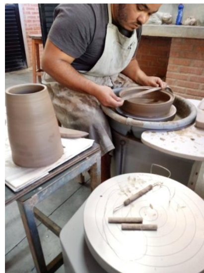
Criação das peças em torno elétrico Stecno SD-208
