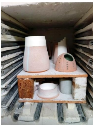
2ª queima do vidro a 1160C° (imagens de antes e depois da queima e das especificidades do forno utilizado)
