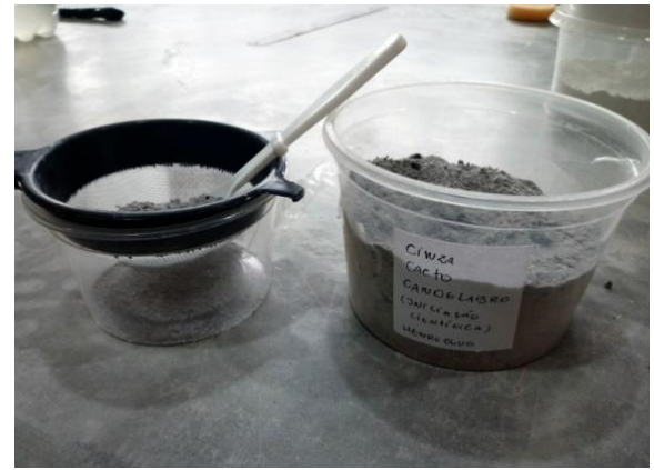
Preparação do vidro de cinzas de cactos: Retirada de partes secas da planta, incineração do material e refinamento das cinzas por peneiramento
