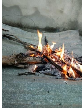
Preparação do vidro de cinzas de cactos: Retirada de partes secas da planta, incineração do material e refinamento das cinzas por peneiramento
