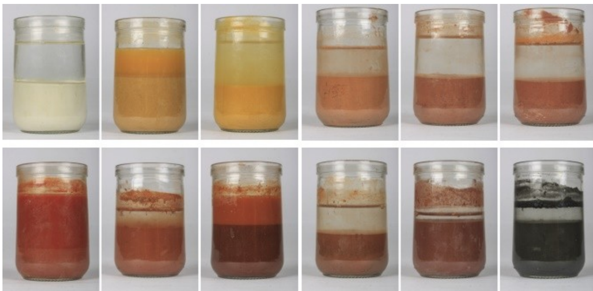
Figura 3.3: Processo de decantação dos pigmentos. Fotos: Marcius Barcelos.
