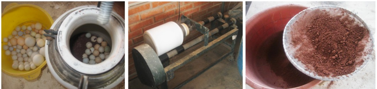
Figura 3.2: Processo de moagem aplicado em todos os pigmentos. Fotos: Lílian Góis
