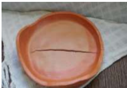
Rachadura no meio da peça
