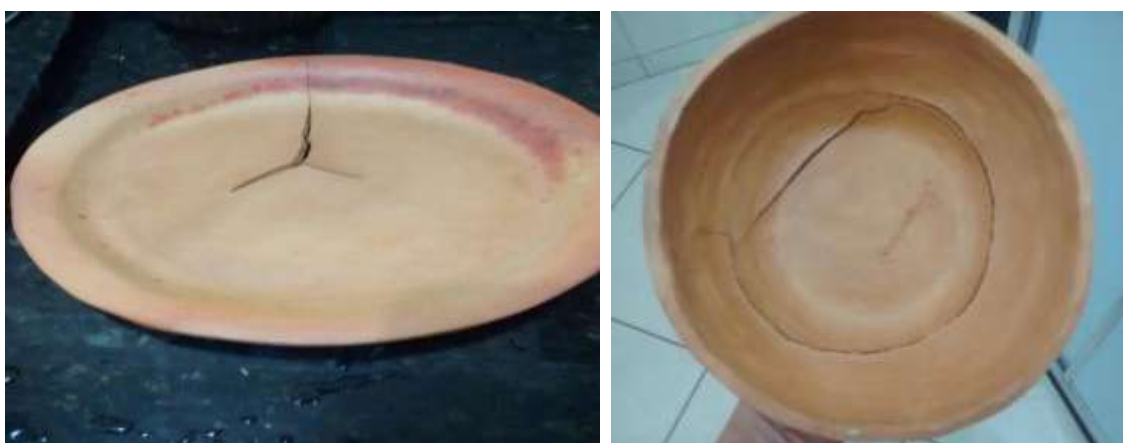
Figura 9: Estas peças trincaram após a queima de biscoito
