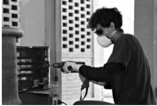
Figura 1: a) Faz-se o corte no latão em 1/3 do tamanho total; b) Fazem-se furos na tampa e nas laterais para atravessar o arame para ser amarrado; c) Corta-se a manta com o diâmetro da tampa do latão e mede-se o comprimento da manta em relação à parede. Aproximadamente 1,8m.
