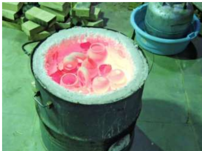
Figura 9: Forno de latão aberto com peças dentro incandescentes (1000°C)
