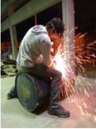
Figura 1: a) Faz-se o corte no latão em 1/3 do tamanho total; b) Fazem-se furos na tampa e nas laterais para atravessar o arame para ser amarrado; c) Corta-se a manta com o diâmetro da tampa do latão e mede-se o comprimento da manta em relação à parede. Aproximadamente 1,8m.
