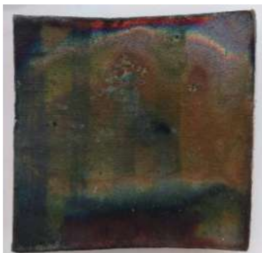
2ª Queima, Amostra I (aguada aplicada via pincel); 2ª Queima Amostra II (aguada aplicada via pincel)
