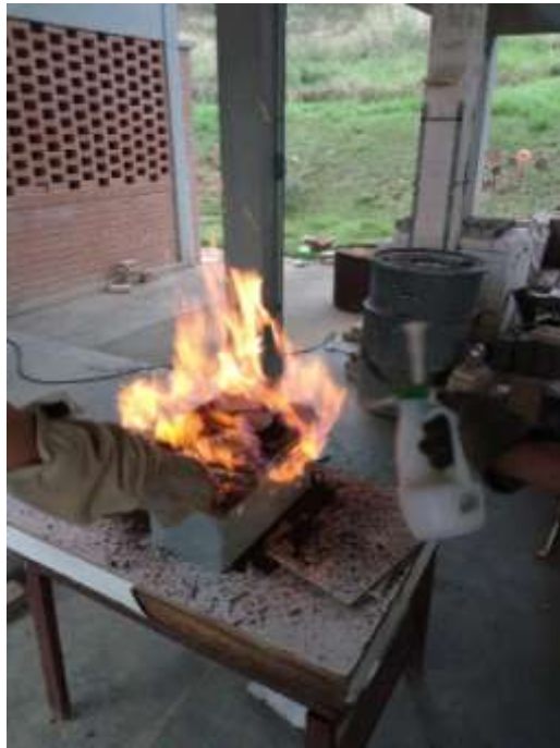
Aplicação do álcool via compressor.
