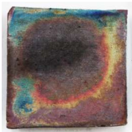
2ª Queima, Amostra I (aguada aplicada via pincel); 2ª Queima Amostra II (aguada aplicada via pincel)
