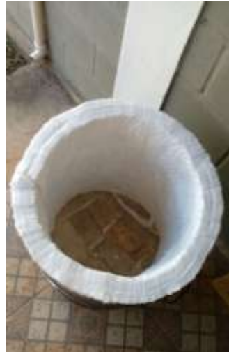
Figura 2: a) Preenche-se com tijolos refratários ou isolantes a parte inferior do barril; b) instalam-se as alças e corta-se a manta para a entrada do maçarico e da chaminé
