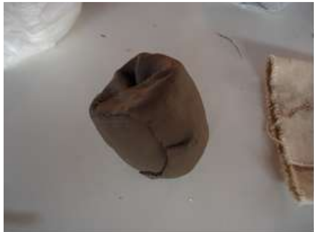
Placa de argila (mufla) para envolver o corpo de prova e fixar o sulfato de cobre (pó azul), o capim e a serragem (esq.) Mufla pronta para ser colocada dentro do forno (dir.)
