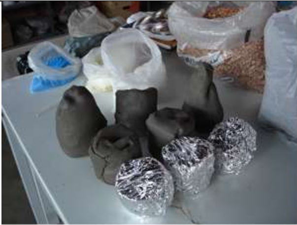
Muflas de argila e papel alumínio prontas para irem ao forno e serem queimadas (esq.) Muflas de placas de argila e papel de alumínio dispostas dentro do forno para serem queimadas (dir.)
