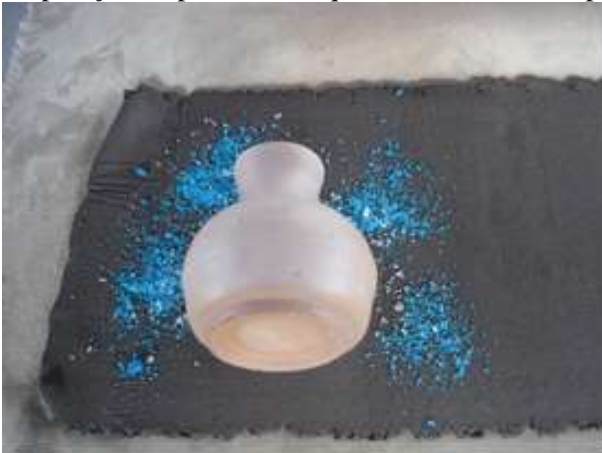
Placa de argila (mufla) para envolver o corpo de prova e fixar o sulfato de cobre (pó azul) e o sal grosso (esq.) Placa de argila (mufla) para envolver o corpo de prova e fixar o sal grosso, o capim e a serragem (dir.)
