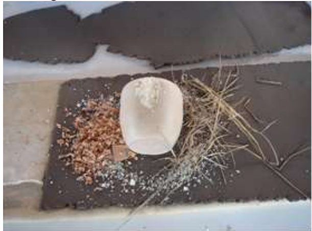
Placa de argila (mufla) para envolver o corpo de prova e fixar o sulfato de cobre (pó azul) e o sal grosso (esq.) Placa de argila (mufla) para envolver o corpo de prova e fixar o sal grosso, o capim e a serragem (dir.)
