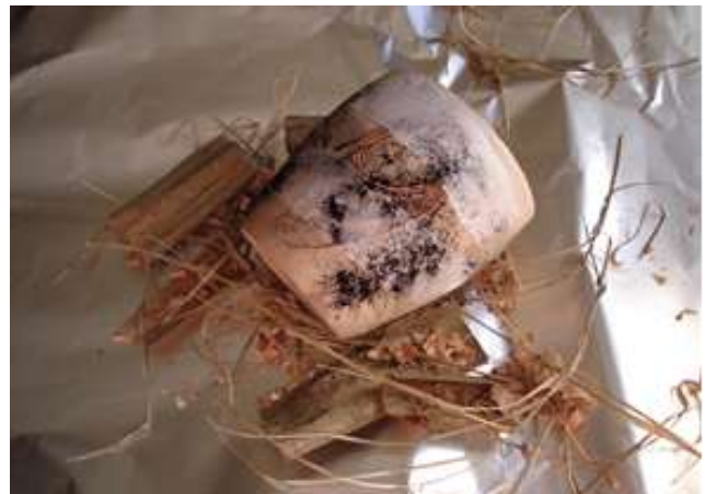
Papel alumínio (mufla) para envolver o corpo de prova e fixar os materiais junto à peça. Os materiais utilizados foram: capim, serragem, sulfato de cobre dissolvido em água e pincelado no corpo de prova. (esq.) Papel alumínio (mufla) para envolver o corpo de prova e fixar os materiais junto à peça. Os materiais utilizados foram: Capim, folha da cana-de-açúcar fio de cobre enrolado e fixado com fita crepe, óxido de cobre e sal grosso. (dir.)
