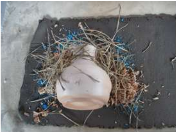
Placa de argila (mufla) para envolver o corpo de prova e fixar o sulfato de cobre (pó azul), o capim e a serragem (esq.) Mufla pronta para ser colocada dentro do forno (dir.)
