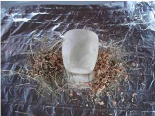
Papel alumínio (mufla) para envolver o corpo de prova e fixar os materiais junto à peça. Os materiais utilizados foram: capim, serragem, sulfato de cobre dissolvido em água e pincelado no corpo de prova. (esq.) Papel alumínio (mufla) para envolver o corpo de prova e fixar os materiais junto à peça. Os materiais utilizados foram: Capim, folha da cana-de-açúcar fio de cobre enrolado e fixado com fita crepe, óxido de cobre e sal grosso. (dir.)
