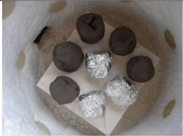
Muflas de argila e papel alumínio prontas para irem ao forno e serem queimadas (esq.) Muflas de placas de argila e papel de alumínio dispostas dentro do forno para serem queimadas (dir.)
