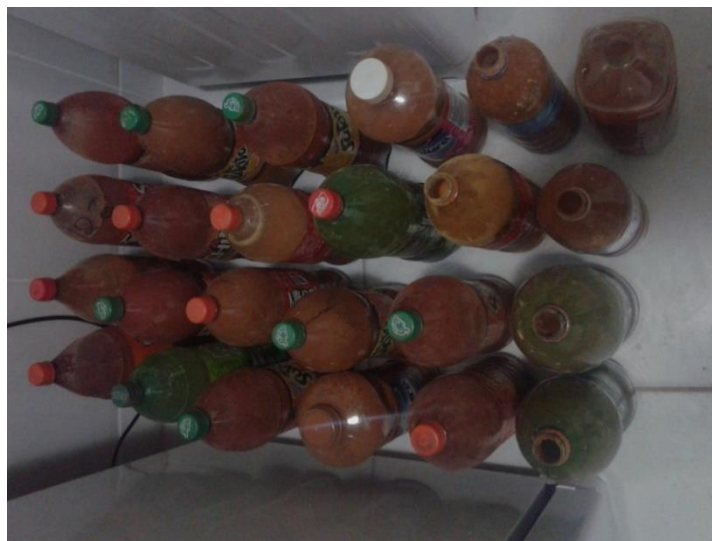
Figura 11-terra colorida em garrafa pet para realização do processo de decantação,2019.
