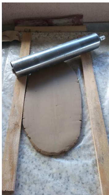
Figura 13-Utilizando rolo de metal para abrir as placas com guias de madeira para padronizar a espessura da placa
