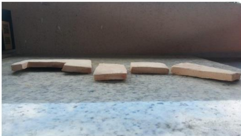
Peças empenadas (Problema ocorrido durante o processo de secagem)
