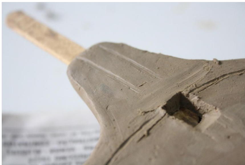
Fig.3.27 Palito que atravessa do bocal para a caixa de ressonância. Em sequência o corte inicial para criarmos o caminho do ar.
