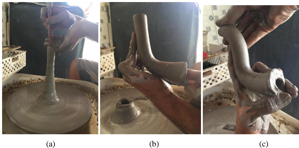
Foto 13: 5ª Etapa: Cilindro erguido (a), afinado com ajuda do pincel (b), modelagem e dobra do bico (c). Acervo pessoal, 2020.
