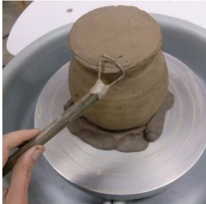
Figura 25 – acabamento dos vasos no torno, utilizando ferramentas
