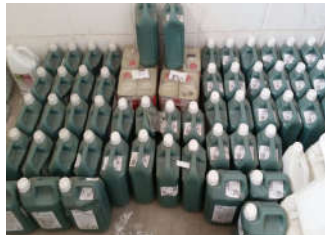
Armazenamento inadequado, diretamente no chão, sem utilização de pallet's
