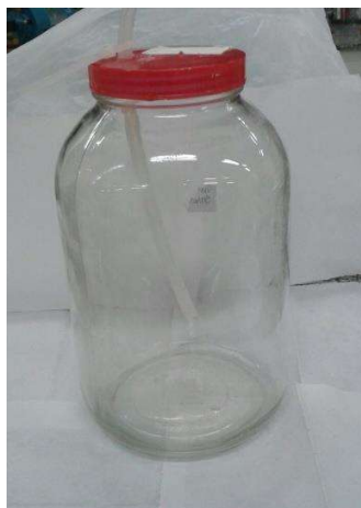
Figura 5 – Biorreator preparado para a produção do fermentado de abacaxi.
