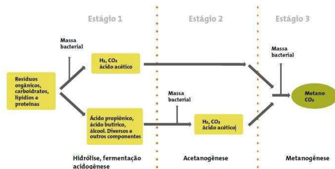
Figura 5. Processo esquemático de biodigestão anaeróbia a partir de matéria orgânica.
