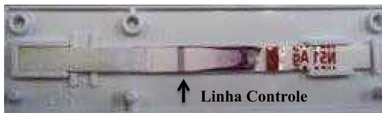
Figura 14. Teste impregnação do antígeno na membrana Millipore Prima 125 bloqueada com uma solução contendo albumina e utilizando tampão de corrida PBS tween 0,05%.
