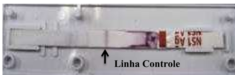
Figura 15. Teste impregnação do antígeno na membrana Millipore Prima 125 bloqueada com uma solução contendo leite e utilizando tampão de corrida Tris 100 mM pH 7,4.
