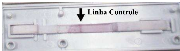
Figura 16. Teste imunocromatográfico montado com as seguintes membranas: Whatman Wick C083, Whatman Prima 125, Fusion 5 e Whatman Sample 2668. A corrida foi realizada com o tampão PBS tween 0,05%.
