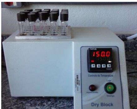
Foto 9– bloco digestor de DQO (reator para DQO)- Dry Block.
