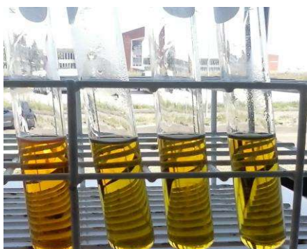
Foto 11- reação formada após passar pelo reator para DQO.
