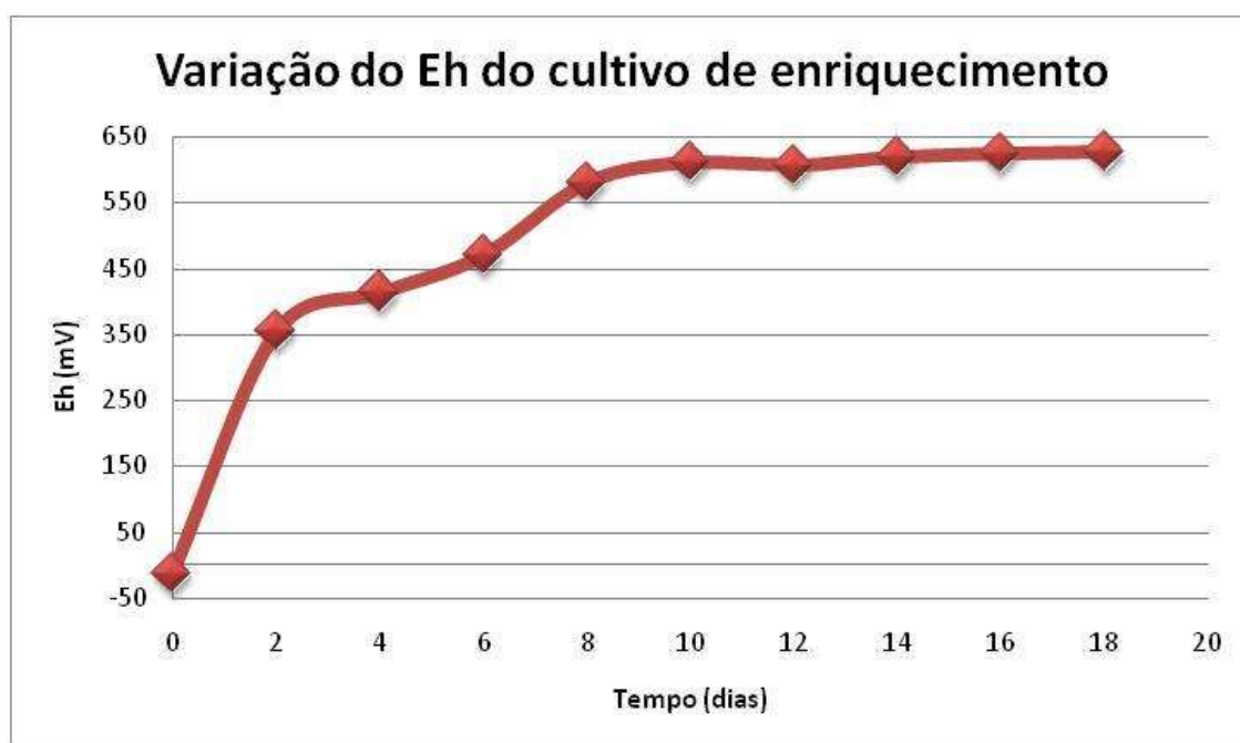
Figura 5.4: Variação do Eh do cultivo de enriquecimento de At. ferrooxidans endógena em função do tempo.
