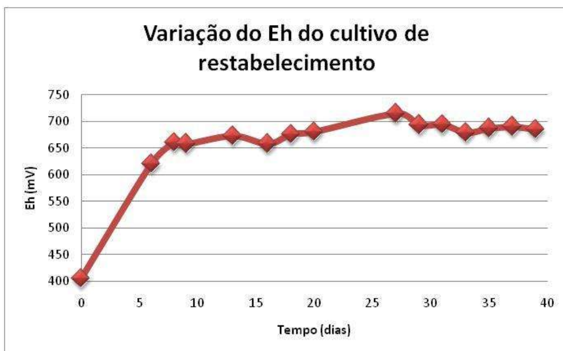
Figura 5.2: Variação do Eh do cultivo do inóculo de At. ferrooxidans em função do tempo.
