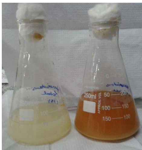
Figura 5.1: Coloração do meio de cultivo antes (frasco da esquerda) e depois do crescimento de At. ferrooxidans (frasco da direita), atingindo Eh maior que 600mV. As condições de cultivo foram 35°C, pH 1,75 e agitação 150min -1 .
