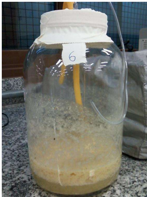
Figura 6. Biorreator de número 6, correspondente ao ponto central do planejamento experimental, mostrando no fundo uma fase líquida e a formação de espuma logo acima.
