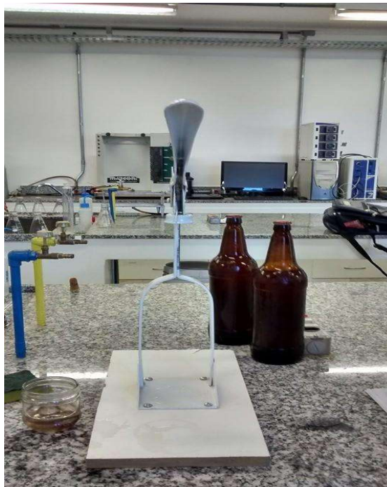
Figura 14 - Arrolhador essencial para inserção das tampinhas e vedação das garrafas de cerveja.
