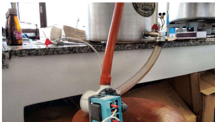
Figura 7 – Recirculação do mosto.
