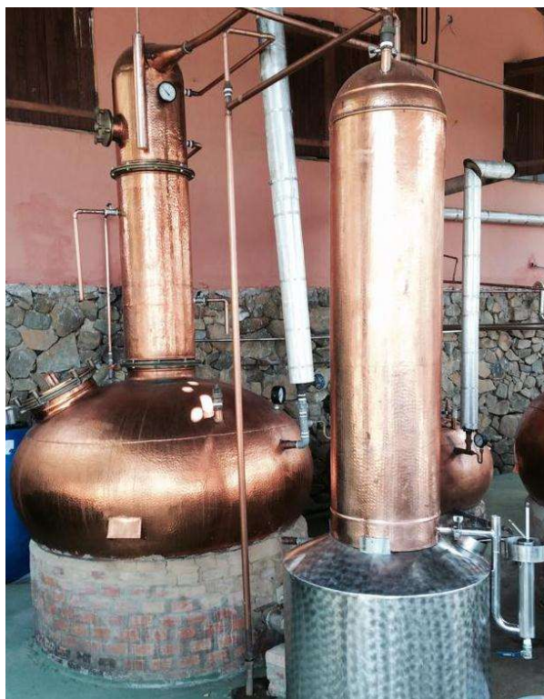
Figura 1. Imagem de um alambique confeccionado em cobre para processos artesanais.
