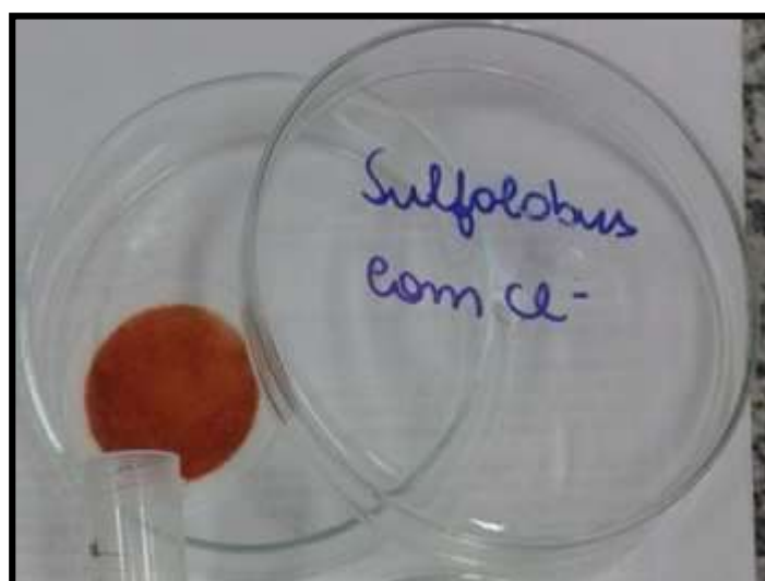
Figura 4.1 – Membrana de celulose 0,22 \mu\text{m} , obtida após filtração do meio de biolixiviação de calcopirita, cultivado na presença de cloreto de potássio a 70°C.
