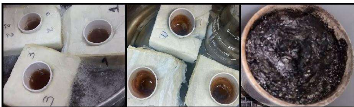
Figura 11. Etapas da secagem das amostras em banho-maria fervente e carbonização em bico de Bunsen.
