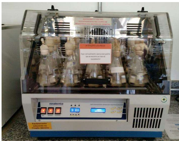
Figura 5. Câmara rotativa shaker com os 11 erlenmeyer inoculados.
