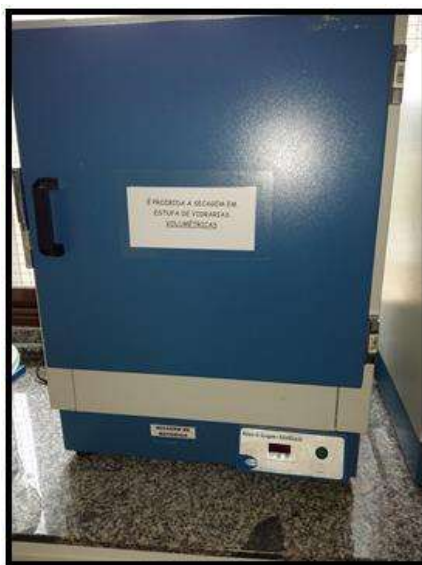
Figura 5. Estufa empregada na secagem das amostras de casca de camarão para determinação do teor de umidade.
