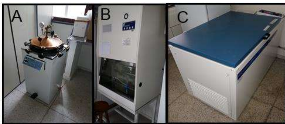
Figura 8. Autoclave utilizado na esterilização das vidrarias e meios (A). Capela de fluxo laminar utilizada na transferência dos pré-inóculos e inóculos aos meios YM, padrão de sacarose e alternativo de casca de camarão (B). Agitador orbital ( shaker ) utilizado na produção do inóculo e na fermentação para produção de goma xantana (C).
