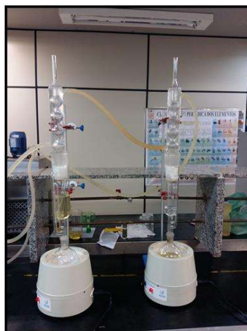
Figura 7. Equipamento montado para extração de lipídios das amostras de casca de camarão pelo método de Soxlet.
