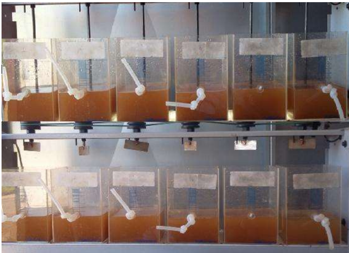
Figura 5.6: Ensaios com solução de amido de milho na concentração de 1% antes e depois da adição da solução nas suas diferentes dosagens.
