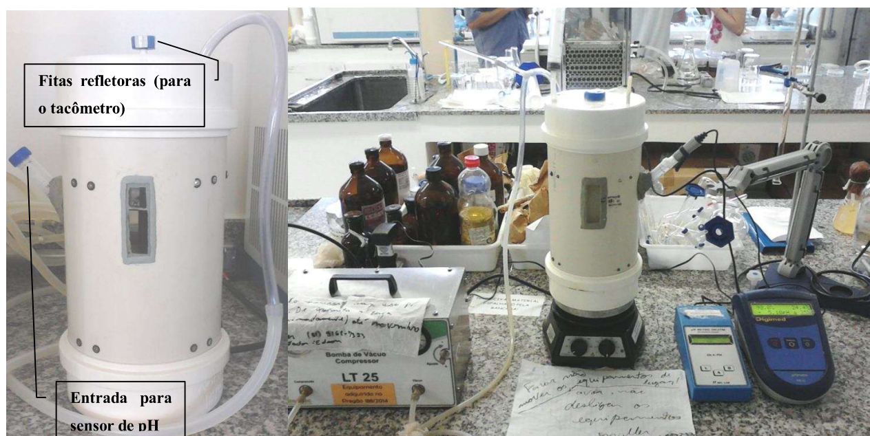
Figura 10- Visão geral do biorreator montado (a) e em funcionamento (b)
