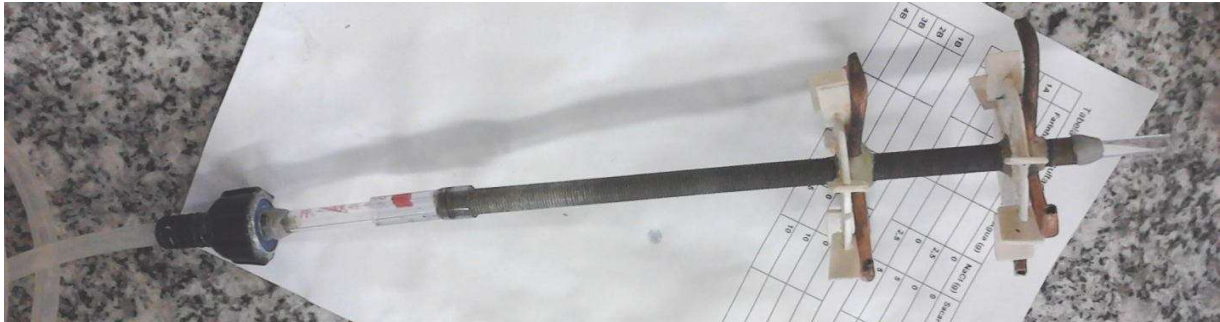
Figura 11- Design do impelidor com propulsores para redução do contato do rolamento com o meio
