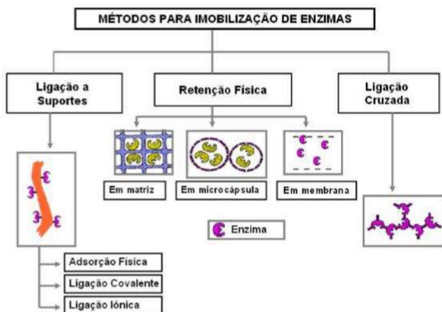
Figura 1.6: Métodos para imobilização de enzimas. Adaptado de [34].
