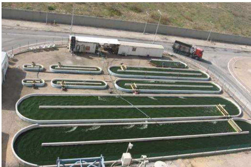
Figura 9. Cultivo de microalgas em tanques abertos (SILVA, 2013).
