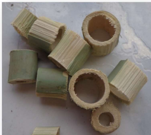
Figura 4.1 Anéis de Bambu para meio suporte do filtro (Arquivo Pessoal).
