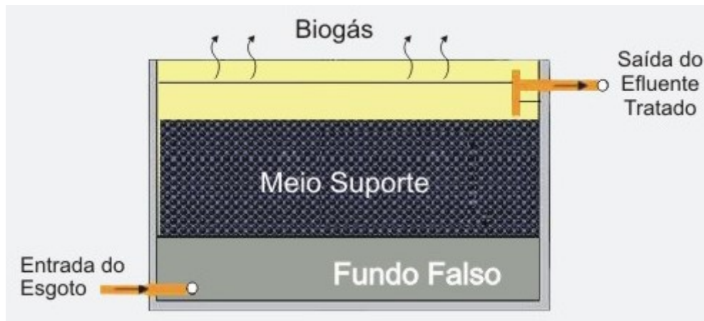
Figura 3.9 Esquema representando um filtro biológico anaeróbico de fluxo ascendente.
