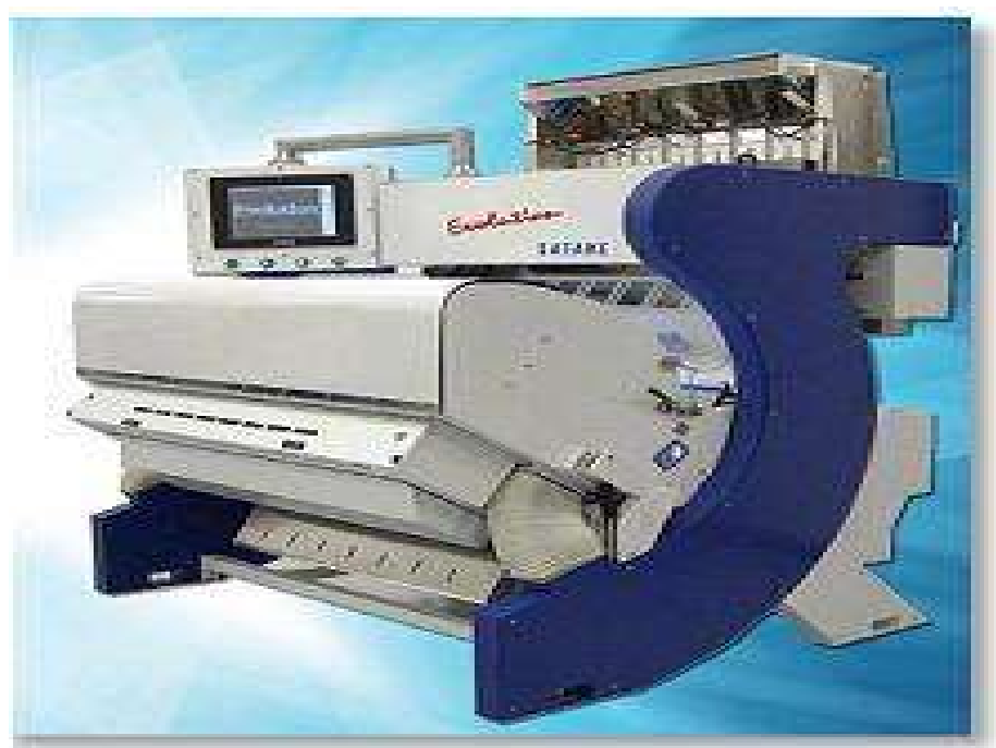
ANEXO F: Color Sorter utilizada na UBS, imagem retirada do manual do equipamento.
