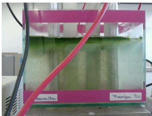
Figura 17: Processo de eletrofloculação com sulfato de amônio a 45 minutos.
