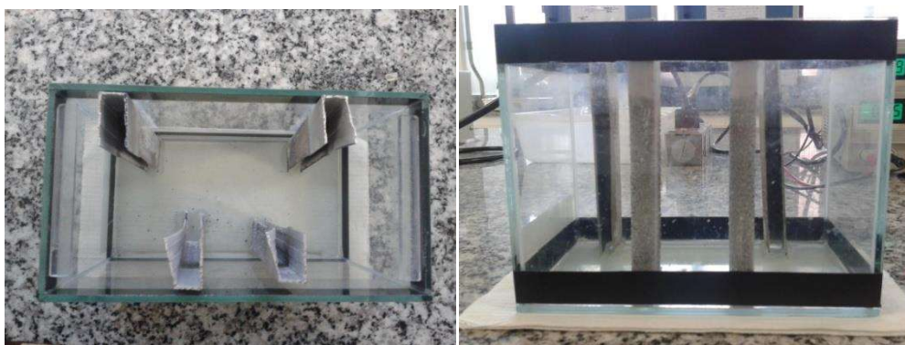
Figura 10: Eletrodos com distribuições e formatos diferentes para análise da flotação, cuja distância dos cátodos é de cerca de 3,0 cm e dos ânodos de cerca de 10,0 cm.
