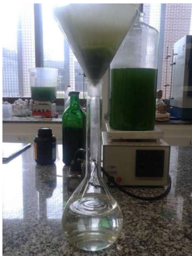
Figura 11: Obtenção da biomassa utilizando filtro de papel.
