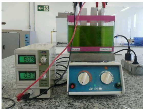
Figura 9: Reator de eletrocoagulação acoplado a fonte de tensão
