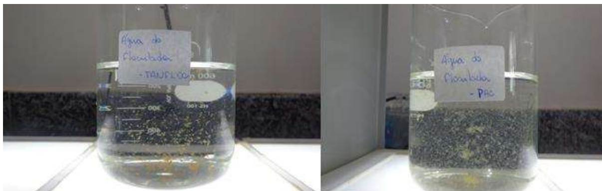
Figura 5.7. Diferença entre os flocos formados na ETA pelos Coagulantes Tanfloc SL e Policloreto de Alumínio.
