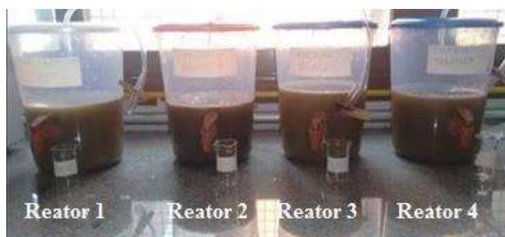
Figura 2: Reatores construídos: Reator 1: levedura selvagem com caldo da cana-de-açúcar estéril; reator 2: levedura selvagem com o caldo da cana-de-açúcar não estéril; reator 3: caldo da cana-de-açúcar não estéril, sem inoculação; reator 4: caldo da cana-de-açúcar estéril e Saccharomyces cerevisiae .
