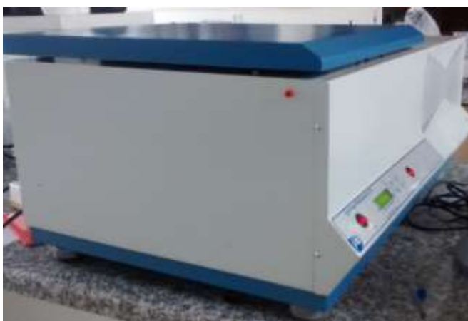
Figura 10 – Centrífuga Refrigerada SL 701, usada para acelerar o processo de sedimentação do material celular gerado no experimento.
