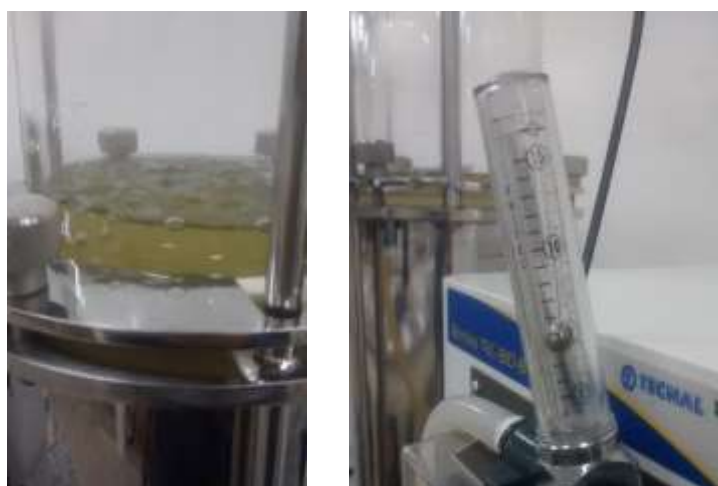
Figura 8 – a) Biorreator “Airlift” em funcionamento. b) Medidor de vazão de ar fixado em 5 Kgf/cm 2 .
