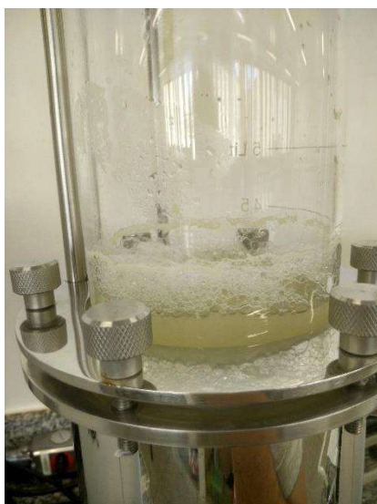
Figura 2 – Biorreator aerado utilizado no processo fermentativo, o cultivo foi realizado em batelada.
