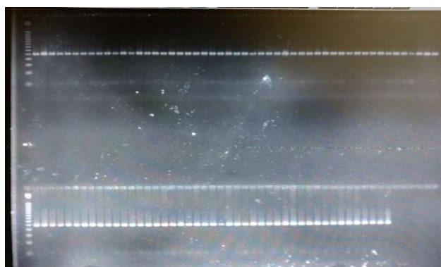
Figura 4: Gel de agarose após revelação de PCR para \beta -lactoglobulina. Fonte: O Autor, 2017.
