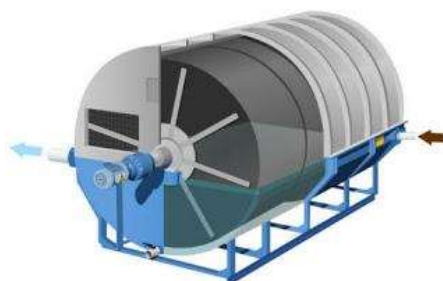
Figura 6. Representação de um biodisco cujo efluente entra por um compartimento (seta marrom) e passa por vários discos em movimento até ser eliminado por outro compartimento (seta azul) do outro lado do sistema.
