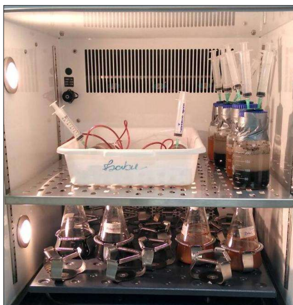
Figura 16: Células de Energia Microbiana e reatores aeróbios e anaeróbios incubados a 32°C. Fonte: O autor.
