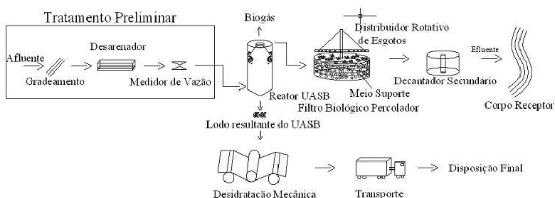
Figura 3. Fluxograma do sistema de tratamento da ETE (Adaptado de Von Sperling, 2005)
