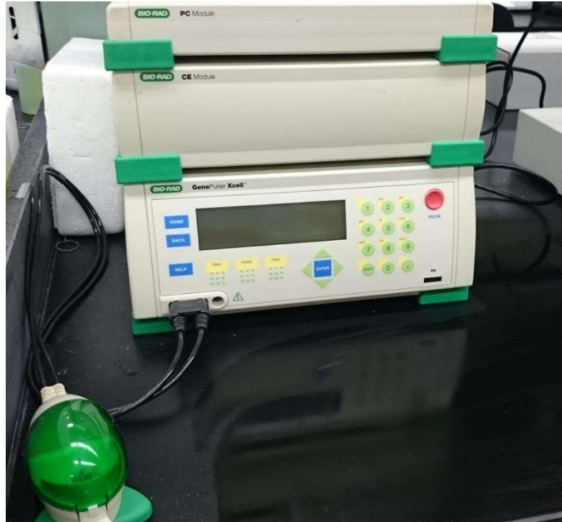
Figura 7: Equipamento de eletroporação Gene Pulser Xcell da Bio-Rad Laboratories do Departamento de Ciências Biológicas da Universidade do Estado da Califórnia ( CSUSM ). O equipamento possui o visor onde as configurações dos processos são determinadas, a câmara onde a cubeta com as células alvo e o gene exógeno são colocados, e o botão vermelho é o pulsor (foto da autora).
