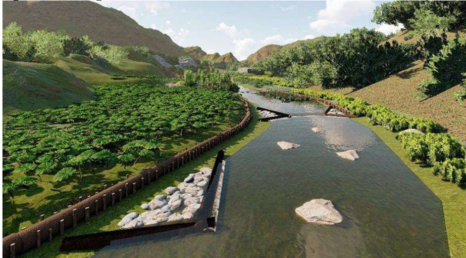
Figura 10: Degraus transversais laterais utilizando troncos e pedras
