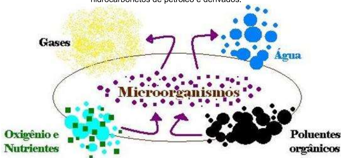
Figura 3 – Esquema básico do processo de biorremediação em um solo contaminado por hidrocarbonetos de petróleo e derivados.
