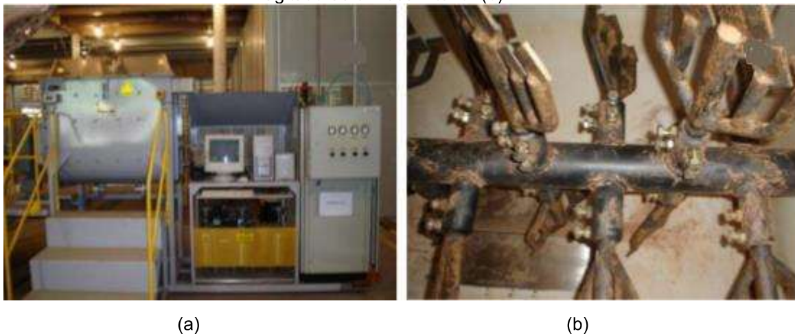
Figura 13 – Biorreator horizontal em escala piloto utilizado no tratamento de solo argiloso contaminado por petróleo acoplado à um sistema de controle computadorizado (a) e das pás agitadoras em seu interior (b).
