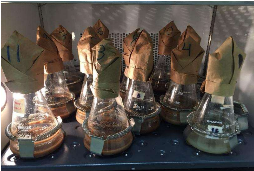
Figura 4 – Chrysosporite Cubensis em erlenmeyers cultivado por 10 dias a 28°C, 150 rpm em agitador orbital (Fonte: Arquivo pessoal).
