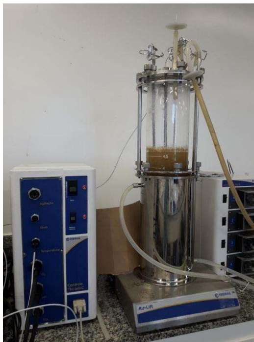
Figura 5 – Biorreator pneumático de 5L, modelo Airlift /coluna de bolha da marca TECNAL em cultivo de Chrysoporte Cubensis cultivado por 10 dias a 28\pm 1^{\circ}\text{C} , aeração 2,0 L/min (0,42 vvm) com meio mineral acrescido de glicose e farelo de trigo em condição otimizada, 12,5 g/L e 20,0 g/L respectivamente. (Fonte: Arquivo pessoal).
