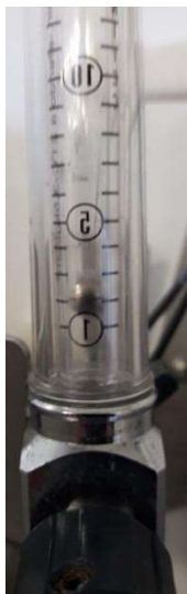
Figura 7 – Medidor de vazão de fluxo de Ar com controle em 2,0 L/min (0,42 vvm), utilizado no cultivo do fungo C. cubensis em biorreator Airlift . (Fonte: Arquivo pessoal)
