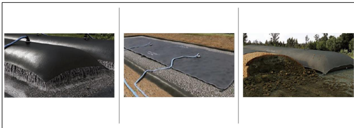
Figura 3.7: Desidratação ou deságue do lodo utilizando Geotubos (BAG)
