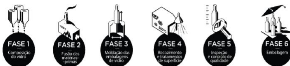
Figura 2 - Fases do processo produtivo de embalagem de vidro. Fonte: Adaptado de COELHO, 2017.
