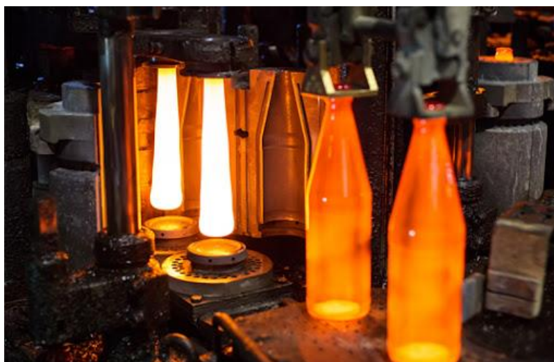
Figura 3 - Processo de sopro de garrafas de vidro.
