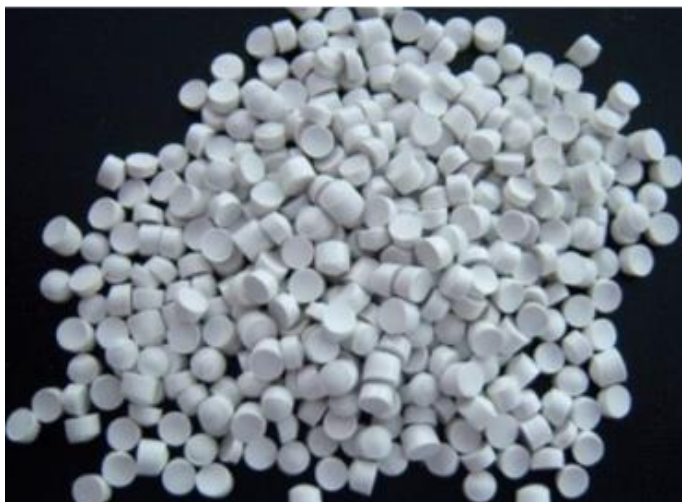
Figura 6 - Pellets de resina PET virgem. Fonte: DUARTE, 2017.
